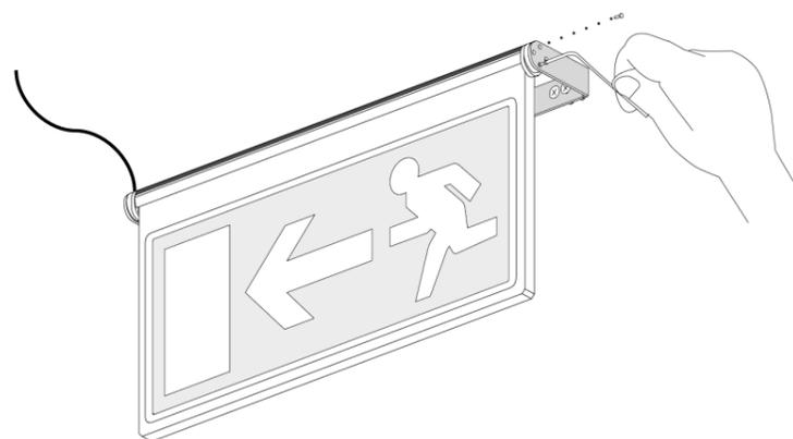
**03.** Inserire le viti fornite negli appositi fori per fissare il corpo lampada.
