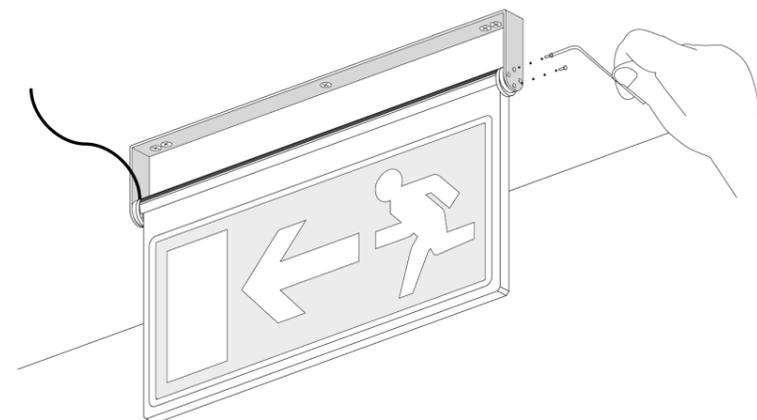
**06.** Inserire le viti negli appositi fori per fissare il corpo lampada.
