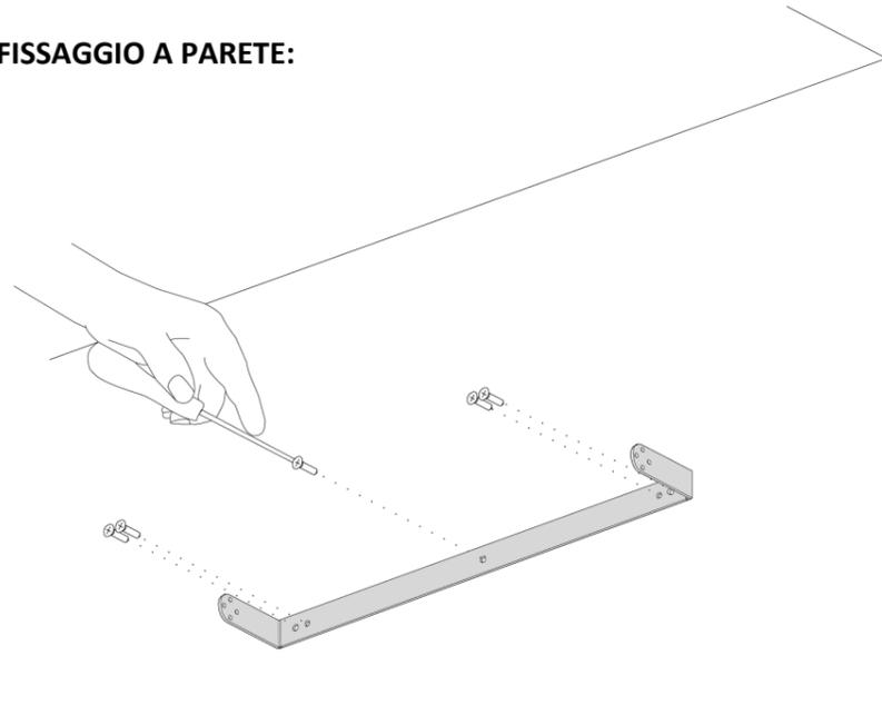
**01.** Smontare la staffa dal corpo lampada e fissarla a parete con tasselli a vite adeguati al tipo di superficie (non forniti)
