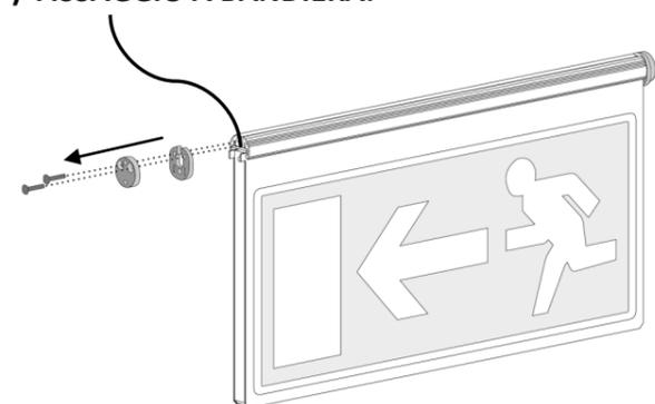
07. Smontare la staffa a parete/soffitto dal corpo lampada e togliere i due elementi di sostegno (lato cavo di alimentazione) del pittogramma tramite le due viti a testa esagonale incassate
