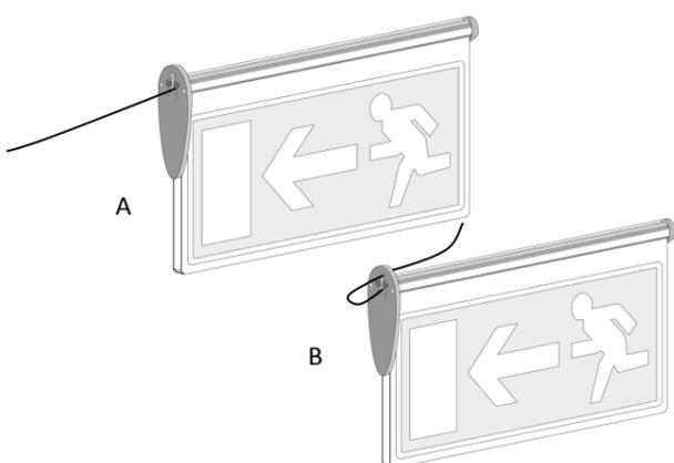
09. E' possibile posizionare il cavo di alimentazione come evidenziato in figura
