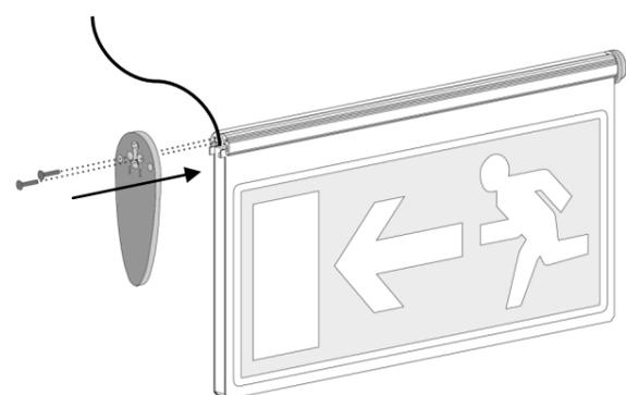
08. Fissare l'apposita staffa in dotazione al corpo lampada, facendo attenzione a far corrispondere le linguette di sostegno del pittogramma alle apposite asole verticali. Serrare la staffa al corpo lampada utilizzando le viti precedentemente smontate al punto 7
